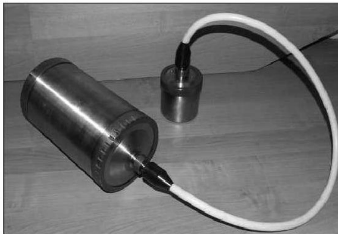
Рис. 4. Блок феррозондового магнитометра lemi-018B
