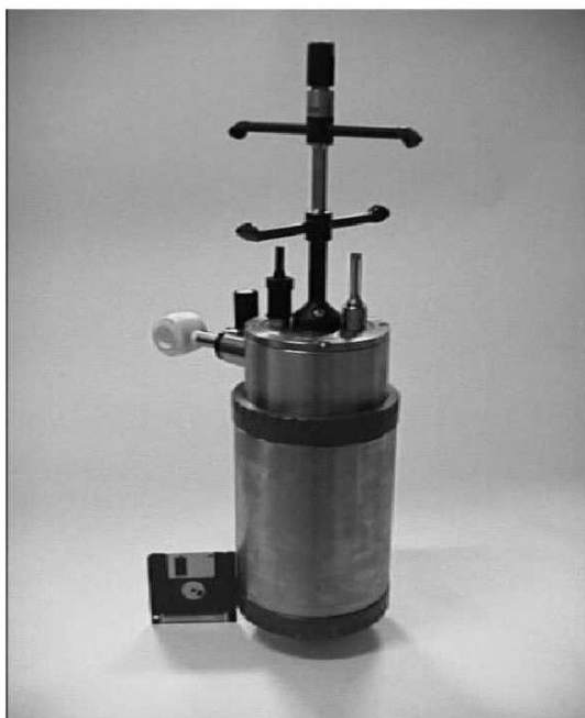
Рис. 3. Блок измерения гидрофизических параметров. Феррозондовый магнитометр
