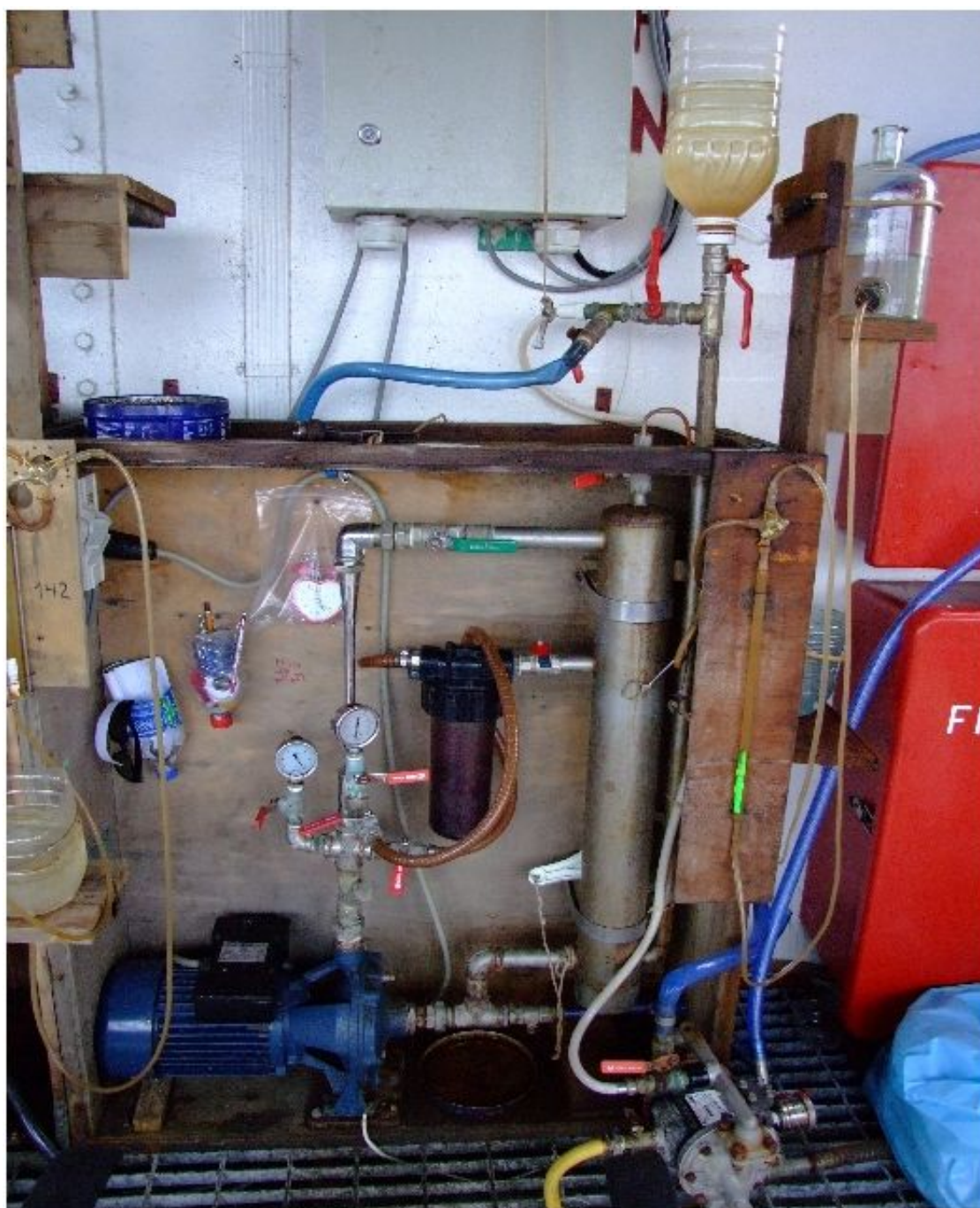
Рис. 1. Установка для дегазации донных осадков на борту судна
