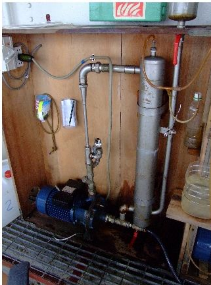
Рис. 2. Установка для дегазации морской воды на борту судна
