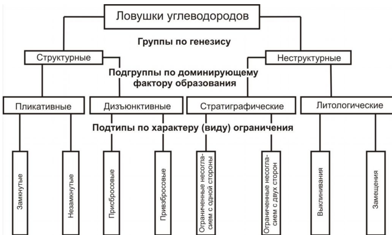
Рис. 3. Классификация ловушек углеводородов по генетическим признакам (Карогодин, 1990)
