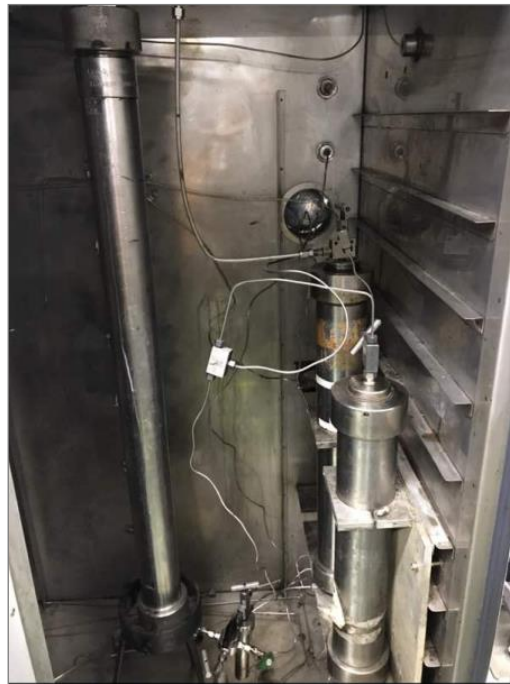
Рис. 2. Фото модели «Slim-tube» в вертикальном положении
