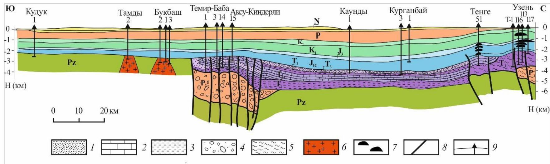
**Рис. 2. Геологический разрез по линии Кудук - Каунды - Узень**
