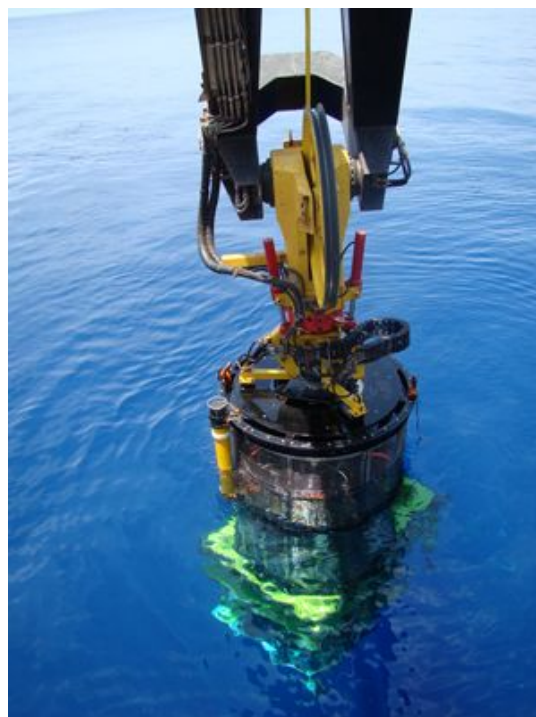
Рис. 6. Уход под воду с жесткой фиксацией к СПУ
