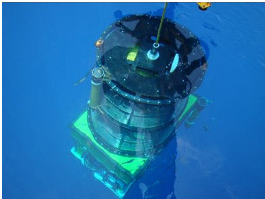
Рис. 7. НПА и гараж отстыкованы от манипулятора СПУ
