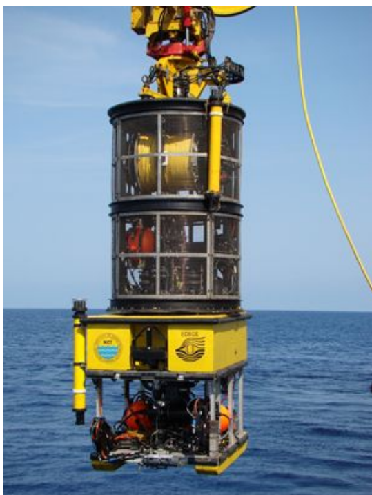
Рис. 5. НПА и гараж выведены за борт (жесткая фиксация к СПУ).
