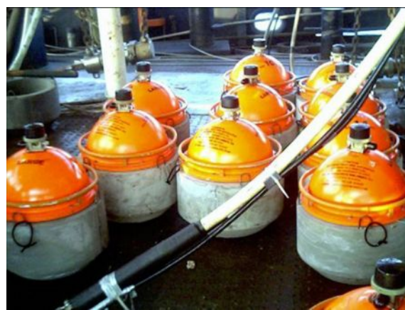
Рис. 11. Донные сейсмостанции готовы к постановке
